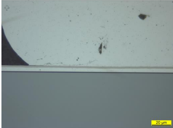
Abbildung 63: Gate-Draht, kurzer Anriss in der „lift-off“ Region
