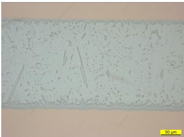
Abbildung 65: DCB Lot, Gefüge unter der Diode
