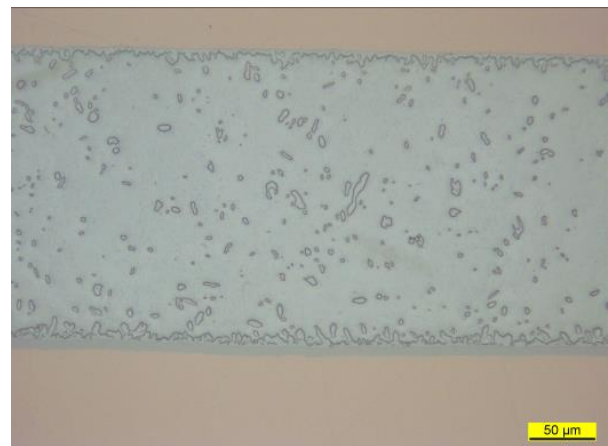
Abbildung 66: DCB Lot, Gefüge unter dem IGBT
