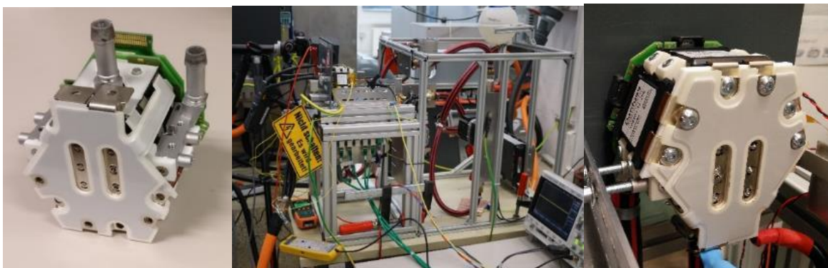
Abbildung 14: physikalischer Aufbau des finalen Umrichters und Darstellung im Prüfstandsaufbau an der FH-Kiel
