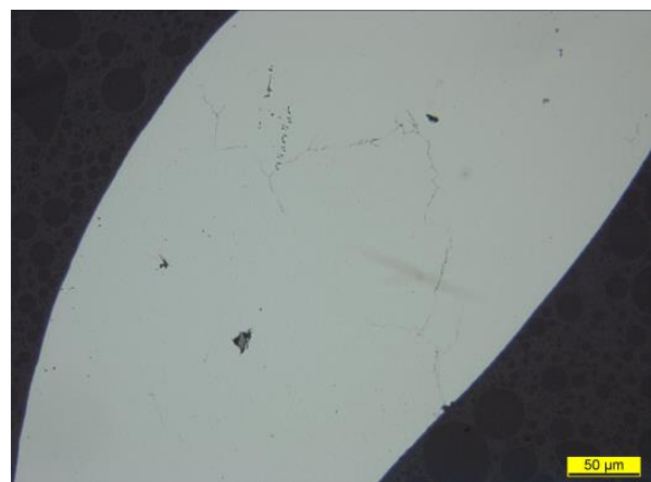
Abbildung 62: Gate-Draht nahe dem Gate Pad
